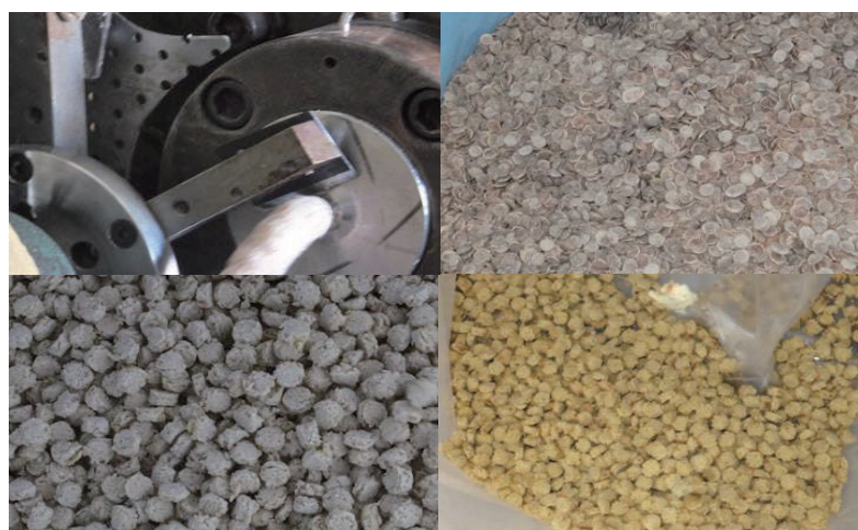
図2 1:切断カッター(左上) 2:あずき膨化試作物(右上) 3:べにばないんげん膨化試作物(左下) 4:ひよこまめ膨化試作物(右下)
